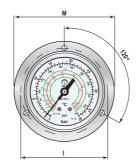
Tipo E montaggio a parete con flangia, raccordo radiale
